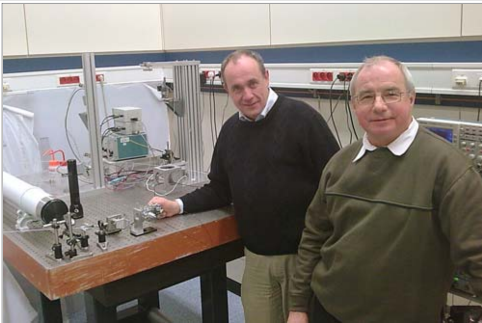
A gauche Gérard Genevès (LNE), à droite Patrick Juncar (CNAM), les deux inventeurs devant la « glissière à photons » un système de contrôle de rectitude de déplacement (quelques nanomètres de précision sur plusieurs mètres de déplacement) © Opticsvalley 2009
