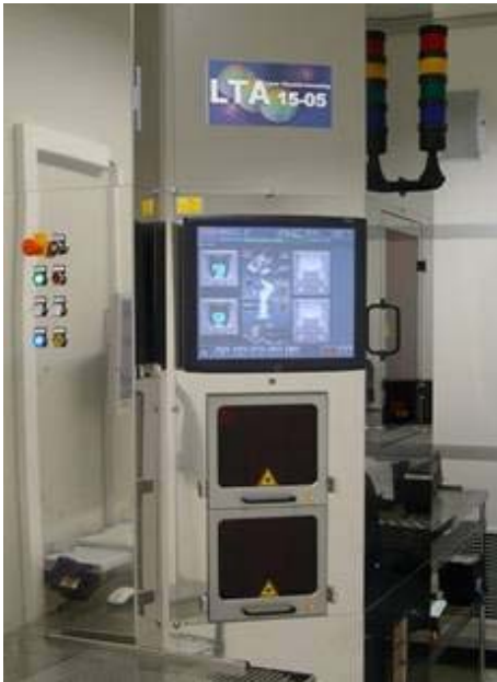
Excico LTA1505TW dédié à la fabrication de composants de puissance
